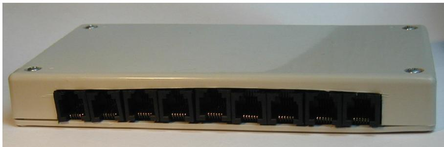
Der HLogger-HUB besitzt alle benötigten Sensor- und Verlängerungsanschlüsse.
